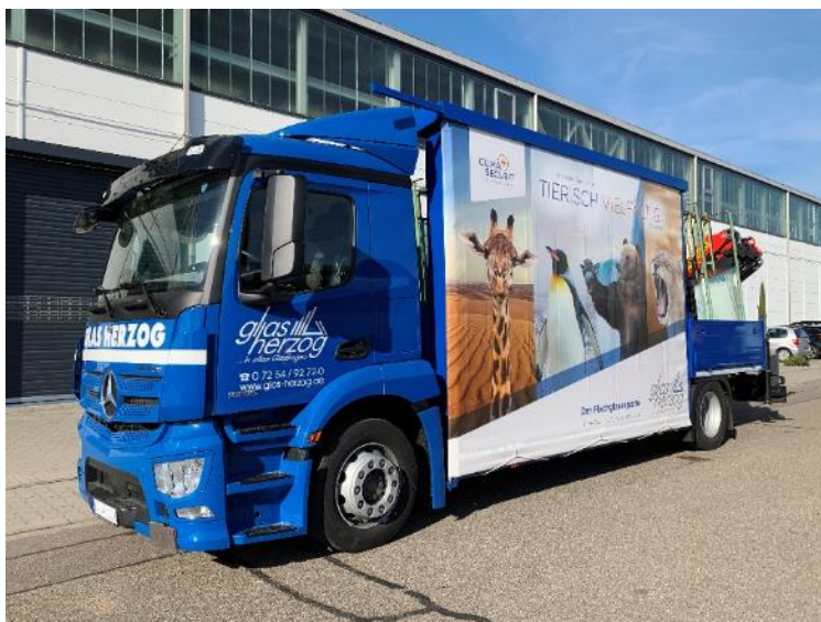
Bild 6: Für fast alle Logistikaufgaben vorbereitet: Zum Branchenfahrzeug umgebauter LKW mit verplantem Glasreff, funkfernbedienbarem Kran und speziell für den Transport von Scheiben und Bauelementen konstruierter Ladepritsche.
