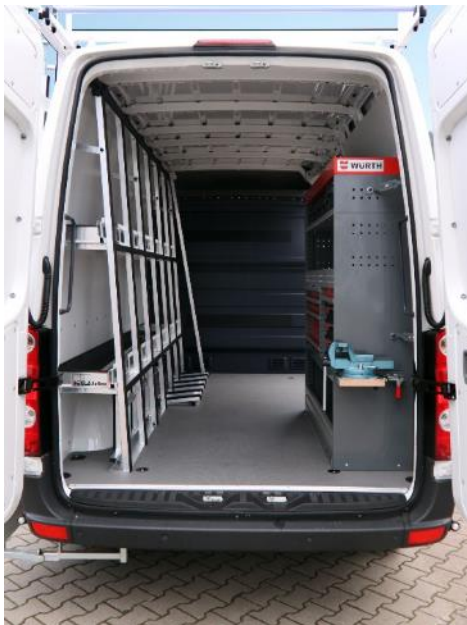
Bild 2: Außen praktisch, innen vielfältig: Kundenindividueller Ausbau mit Reff und zweiteilig klappbarer Auflage, Ablagefächern und Werkzeugschranksystem. Das Ladegut kann entweder auf das Reff gestellt oder an dieses angelehnt fixiert werden.
