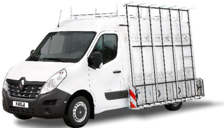
Bild 1: Ideal für eilige Montagen, kleine Liefermengen und für die Auslieferung hochwertiger Sondergläser: Ein zum Branchenfahrzeug umgebauter Transporter mit Glasreff, Dachgepäckträger und Innenreff.
