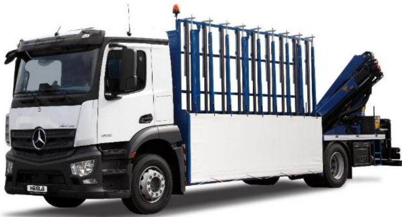
Bild 4 Wenn es mal mehr oder schwerer wird, ist ein LKW das Transportmittel erster Wahl. Das teilverplante Reff bietet zusätzlichen Schutz und setzt ein deutliches Signal für den sorgsamem Umgang mit dem Ladegut.
