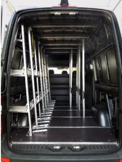
Bild 3: Optimal an das Fahrzeug angepasst ist das Reff mit klappbarer Auflage, das bei Bedarf den Großteil der Fläche beispielsweise für Bauelemente freigibt. Durch Spannstangen und den in Boden und Decke integrierten Lochrastern wird das Ladegut dann bedienerfreundlich und fachgerecht gesichert.
