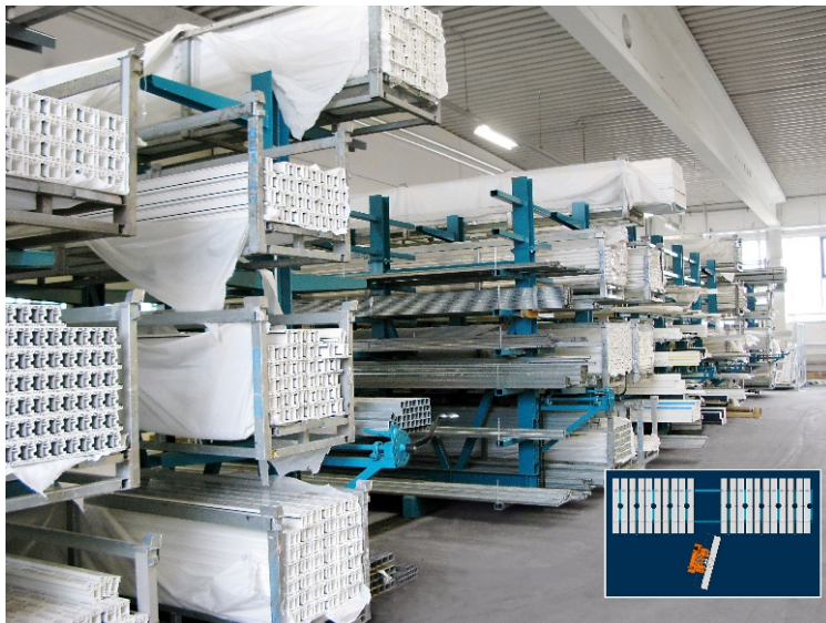
Bild 2: Mit dem quer verfahrbaren HEGLA Langgut-Systemlager kann auf vorhandener Fläche bis zu 50 Prozent mehr gelagert werden. Durch das Verfahren einer Bedienlücke stehen die Paletten im direkten Zugriff.
